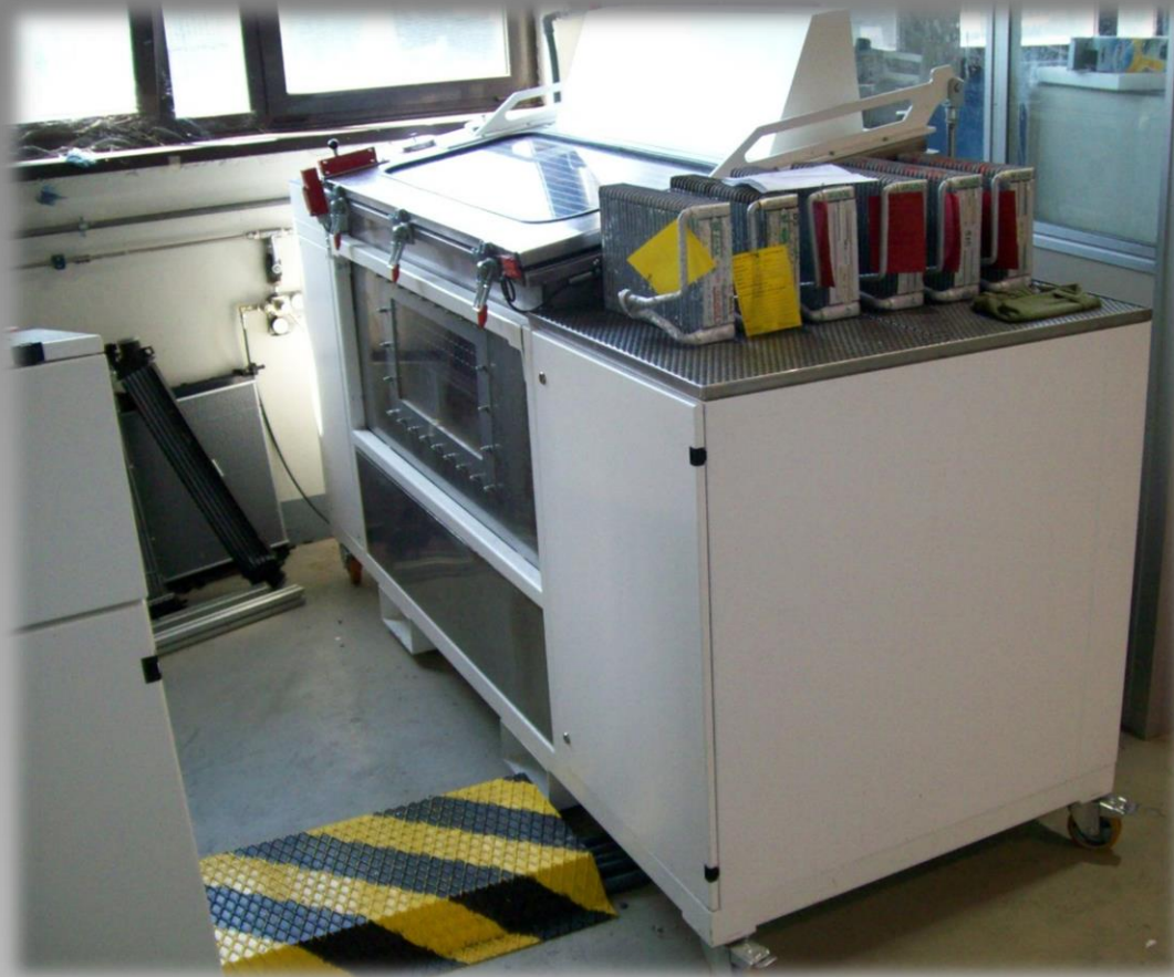
BANCO PROVA TENUTA IN ACQUA B_20895
