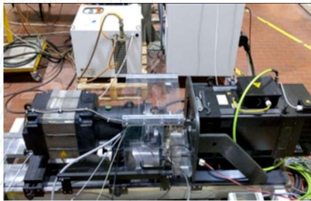
Il banco prova B\_22885 è concepito per eseguire misure di coppia motrice and simulazioni delle condizioni reali di utilizzo di uno specifico motore elettrico.
