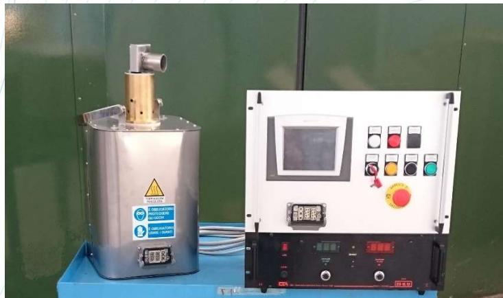
Il generatore di vapore metabolico B\_22186 è progettato per simulare la presenza di un numero variabile di persone all'interno di un abitacolo.
