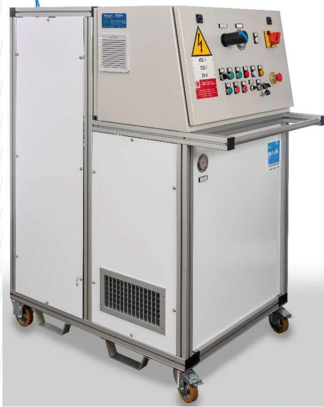
Il banco prova B\_23074 è stato realizzato per mantenere costante, ad un valore impostato dall'utente, la pressione del liquido refrigerante durante test di stress termico su masse radianti posizionate in camera climatica.
