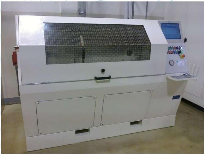
Il banco prova B\_21472 è ideato per test su componenti come tubazioni flessibili o rigide, raccordi, innesti rapidi, valvole, masse radianti ecc.
