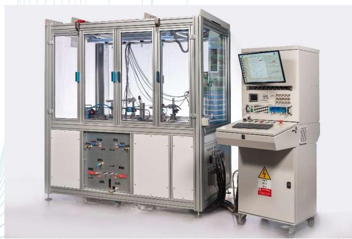
Il banco prova B\_23034 testa le Fuel Supply Units (GAC) per motori Diesel e Benzina.
