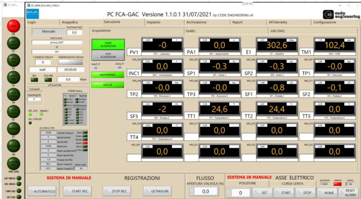
Il banco è provvisto di PC e sistema di acquisizione dati NI.
