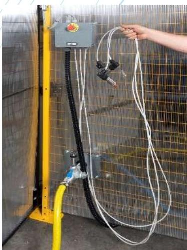
Il sistema di connessione è costituito da un tubo flessibile che veicola l'acqua al componente da testare. 3 trasduttori di pressione, con segnale acquisito, sono disponibili alla posa sul componente in test. Un solo segnale di pressione, definibile dall'operatore, può essere utilizzato per l'attuazione idraulica.
