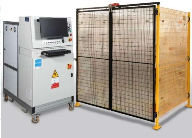
Il banco prova B\_23128 è ideato per la prova fino a scoppio di recipienti in materiale plastico per l'automotive (serbatoi e vaschette di espansione fluido refrigerante).
