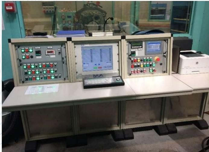
Il banco prova B\_22384 è concepito per eseguire test funzionali di vario tipo sulle trasmissioni meccaniche per i motori aeronautici con un range di prestazioni molto esteso.
