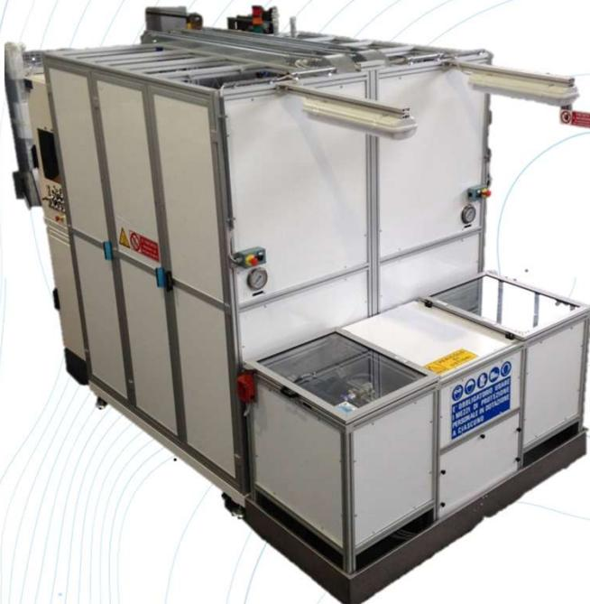
Il banco prova B\_21553 è ideato per eseguire test su masse radianti. Il fluido di prova è glicole etilenico.
