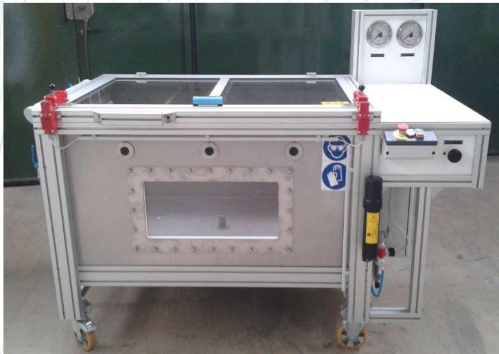
Il banco prova B\_22765 è ideato per eseguire test su masse radianti ed altri componenti.
