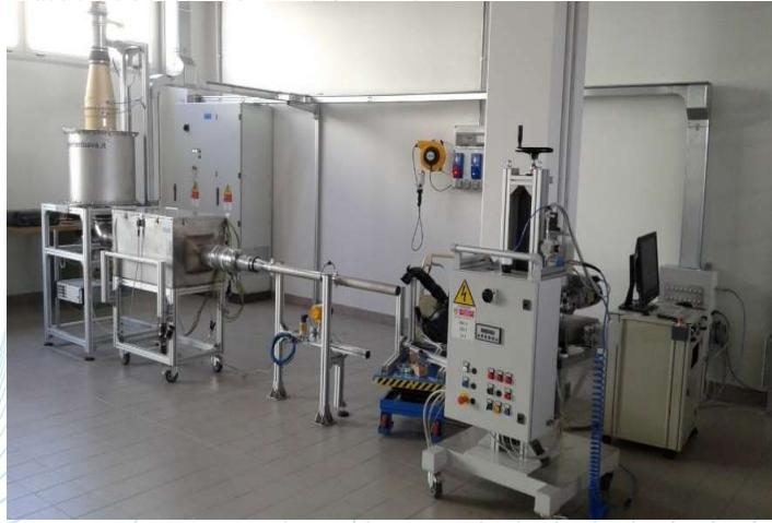
Il banco prova B\_22310 è stato ideato per eseguire test di durabilità su filtri aria motore in accordo alla norma ISO 5011.
