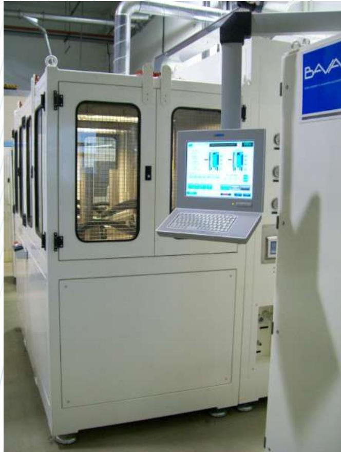
Il banco prova B\_21243 è ideato per testare la resistenza all'erosione interna di scambiatori di calore per impiego automobilistico, facendo circolare al loro interno una miscela composta da acqua corrosiva e liquido refrigerante.
