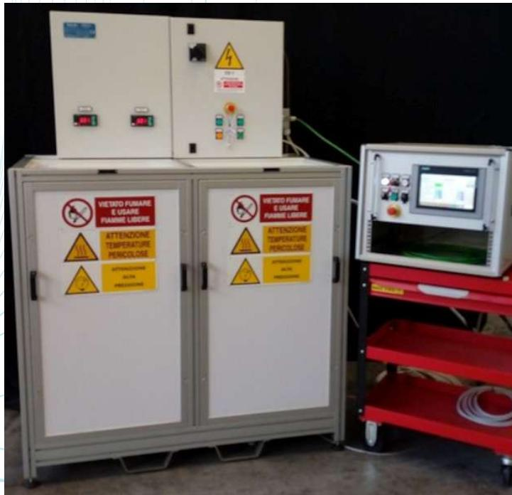
Il banco è ideato come sistema di iniezione fine, in peso, di una predeterminata quantità di gas refrigerante nell'impianto di climatizzazione del veicolo in prova.
